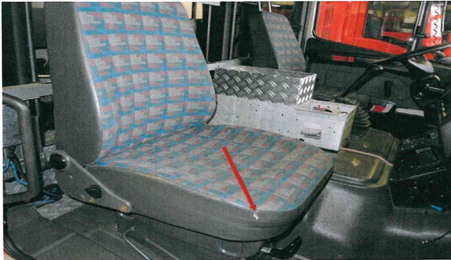
Bild 19 Sitzbezug vorn rechts eingerissen
