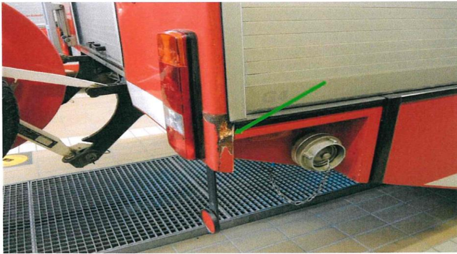
Bild 23 Eckbeplankung hinten rechts stark korrodiert
