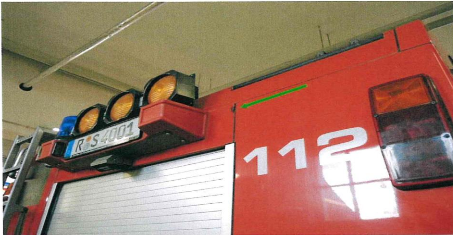
Bild 25 Trägerblech Kennzeichen hinten korrodiert
